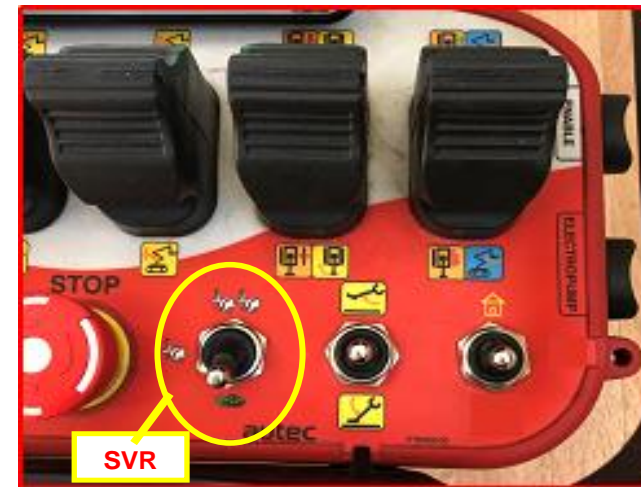
Figure 43 : sélecteur de vitesse sur radiocommande. Pour exécuter une translation en utilisant la radiocommande :
