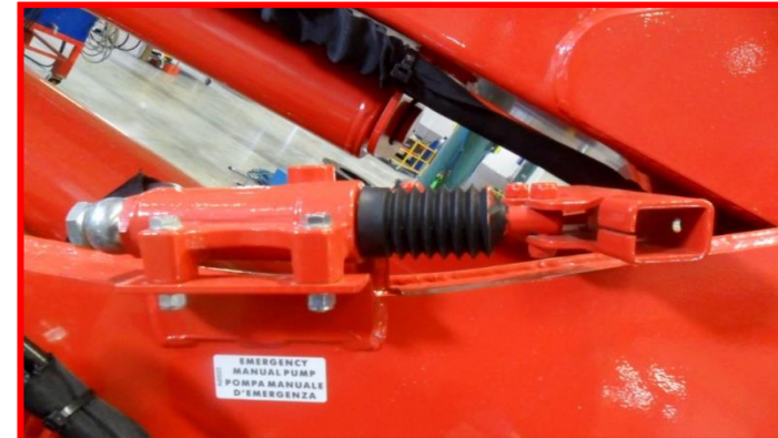
Figure 60 : point d'intégration de la pompe manuelle.
